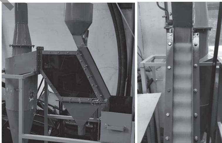
**Рис. 2. Фотография поперечно-поточного классификатора с жалюзийной решеткой**
